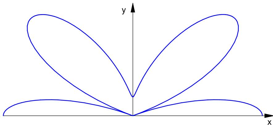
horizontale relative Strahlungsleistungsdichte
