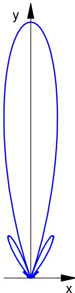
horizontale relative Strahlungsleistungsdichte
