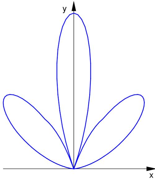
vertikale relative Strahlungsleistungsdichte
