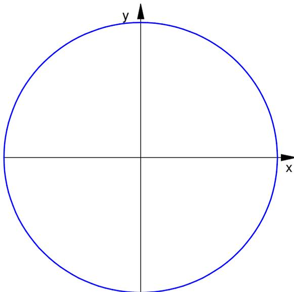
horizontale relative Strahlungsleistungsdichte
